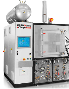
HTK 80 MO/16-3G automatisch, 80 L Nutzvolumen, 1600 °C, Argon, Stickstoff und optionale Wasserstoffausrüstung.
